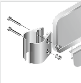
Mit Klemmschelle h=95 VSR 10 für Ø 60 mm VSR 20 für Ø 76 mm
