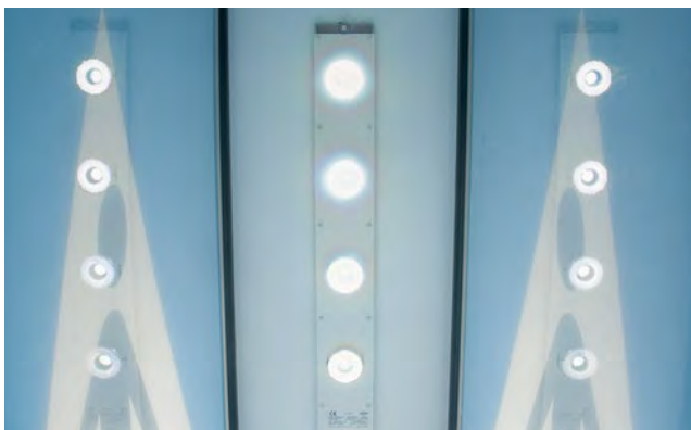
Innenleben eines innenbeleuchteten Verkehrszeichens mit LED-Technik
